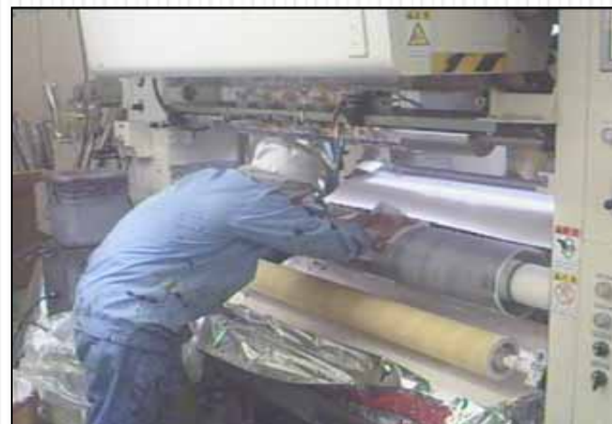
溶剤のふき取り工程
