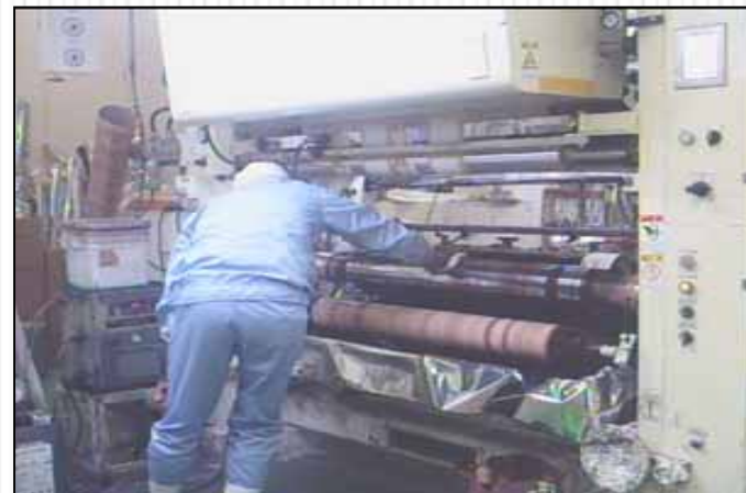
溶剤のふき取り工程
