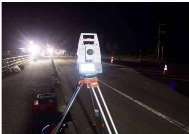
測定者1人でタブレット型携帯端末による視準遠隔操作状況写真
