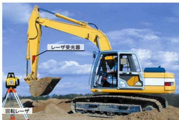
図-6 2Dバックホウの機器構成例
