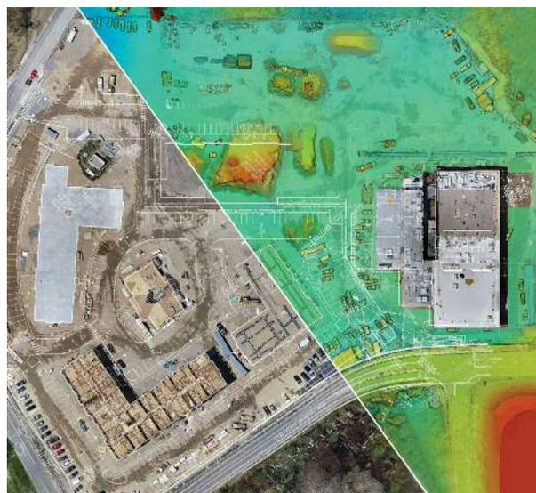
ドローン写真を重ねて生成した3Dモデル
