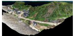
ドローンにより地形を3Dデータ化し崩壊した土量などを迅速に把握
