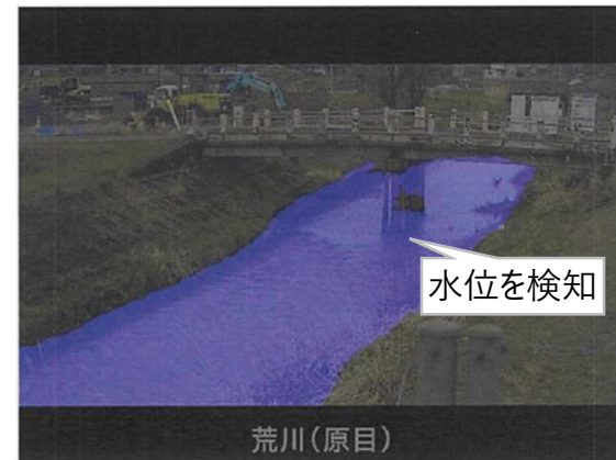
〈河川カメラによる流量観測イメージ〉
