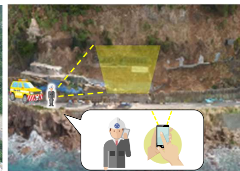
携帯端末カメラによる 3D地形データの取得
