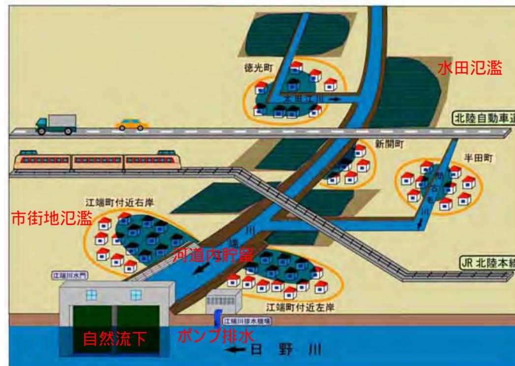
江端川流域の現状の雨水処理分担量のイメージ図
