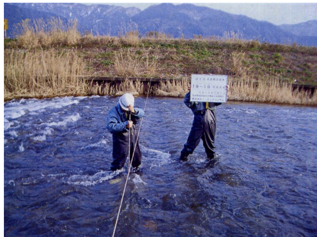
流量観測状況(鱒川)
