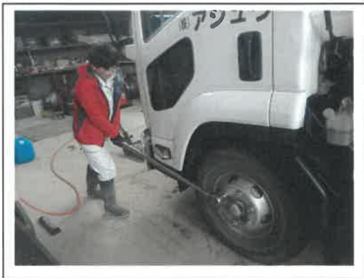
車輪脱落防止点検
