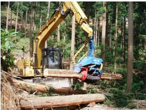
1. 高性能林業機械等による伐倒・搬出
