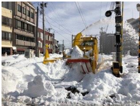
ロータリー除雪車による軌道除雪 (えちぜん鉄道 福大前西福井駅)
