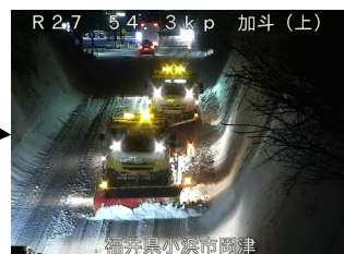
2台の梯団除雪を実施
