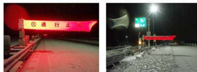
エア遮断機による本線閉鎖状況（敦賀IC①）
