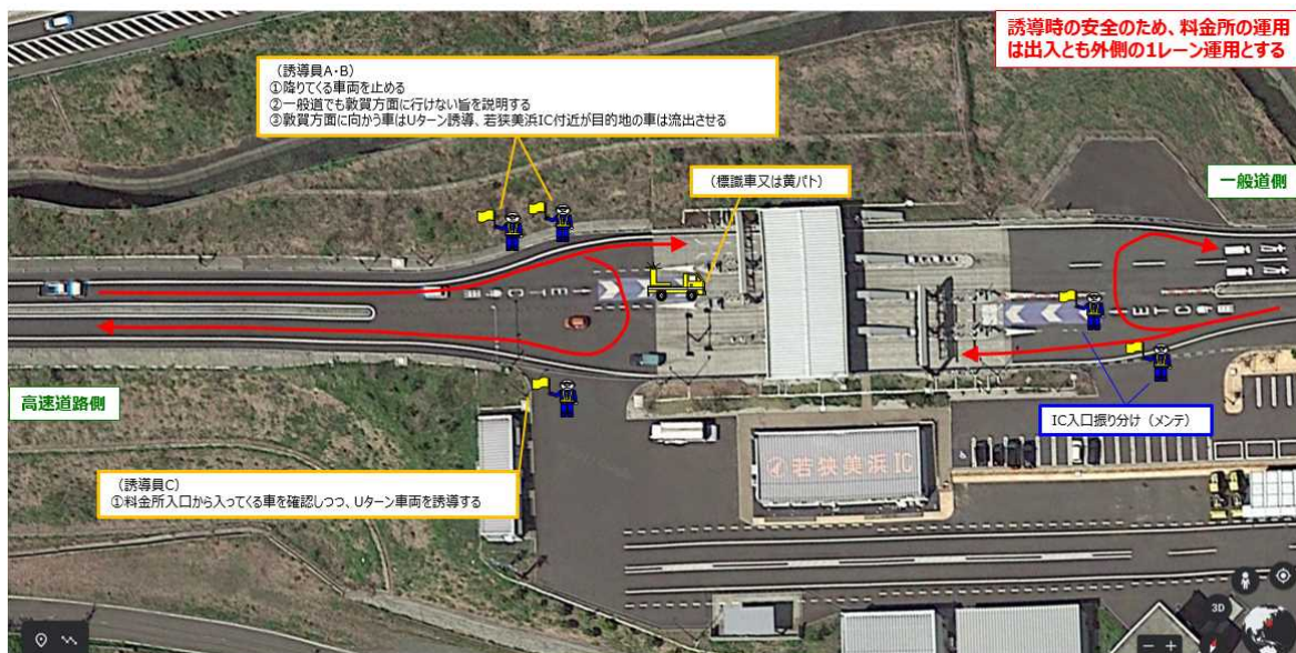
≪ 若狭美浜IC 国道・高速道路同時通行止め・全車Uターン対応イメージ ≫
