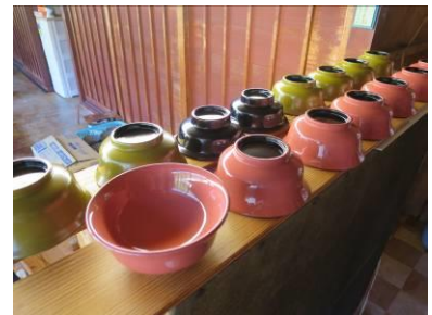
研修生が選んだ色の顔料を混ぜた漆で上塗り
