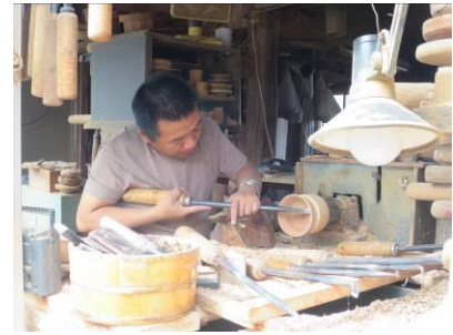
電動ろくろとカンナで木を削る
