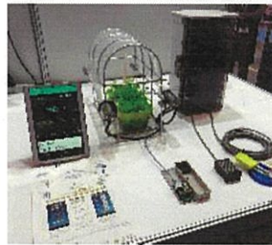
〈農業〉 ビニールハウス環境制御装置
