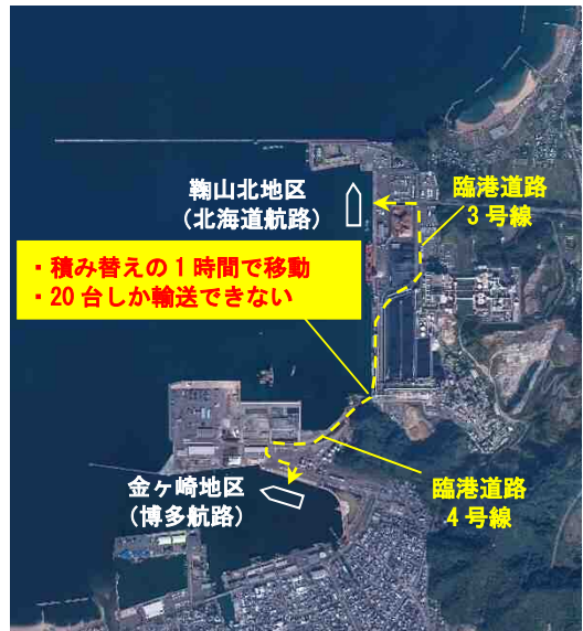
内貿 RORO 貨物の横持ち状況
