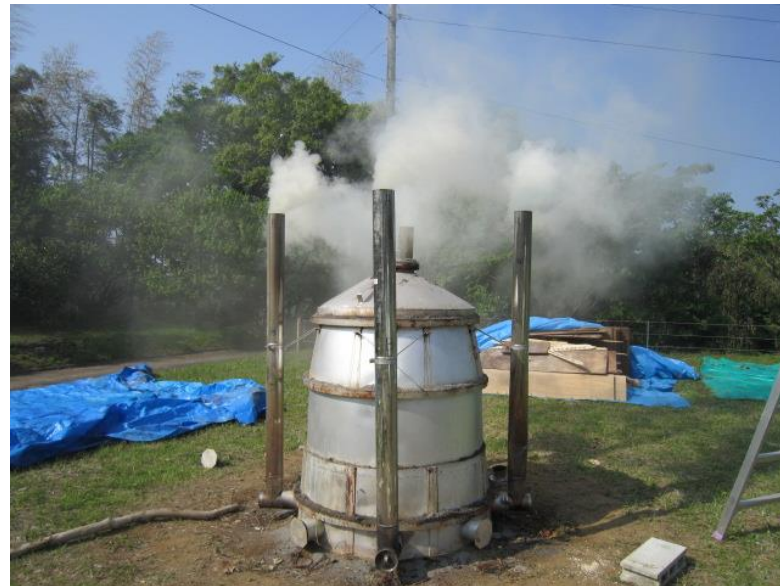
炭化炉のふたを被せて煙突からの液体(木酢液) を採取する(3)
