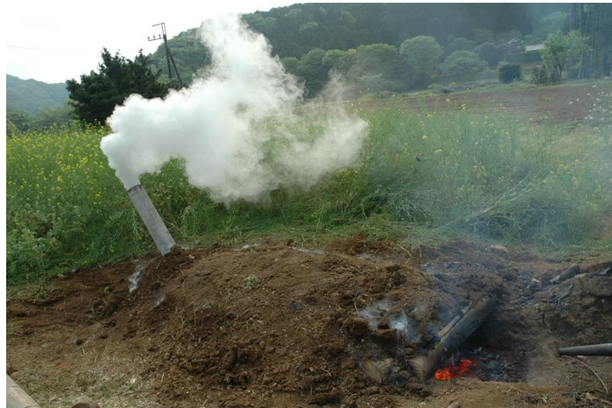
勢いよく出る煙- 煙突で冷えた煙は凝縮して酢液となって滴り落ちる (3)
