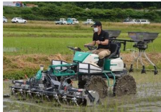
有機肥料散布機付き水田乗用除草機 (農業試験場が企業と共同開発)
