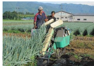
ネギの機械化一貫体系 (掘取機)
