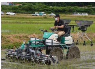
有機肥料散布機付き水田乗用除草機（農業試験場が企業と共同開発）
