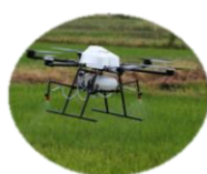
マップに合わせてドローンで肥料を自動散布
