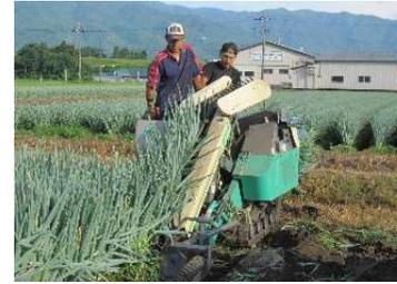
ネギの機械化一貫体系（収穫機）
