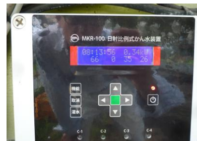
図3 日射比例式灌水装置
