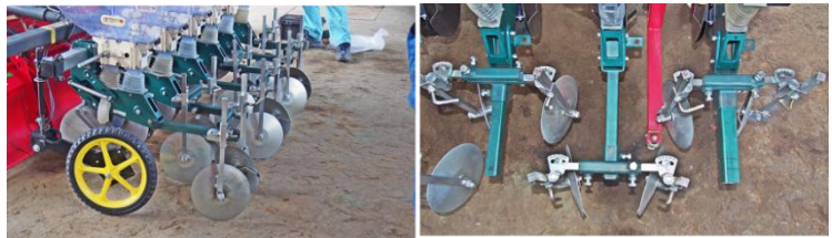
図2 小畦立て播種装置装着図。ベース:RXG-6PSE(アグリテクノ矢崎) 既存の播種機の覆土板をはずし、鎮圧輪を小畦立て装置に換装する。
