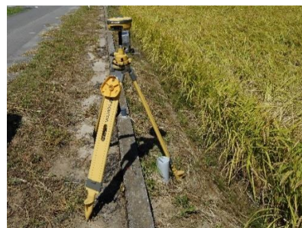
図2 GNSS装置の基地局
