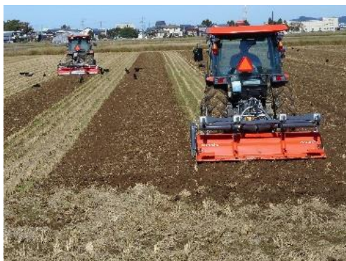
図1 同一圃場で2台のトラクタで協調作業（耕うん）
