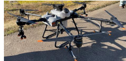
第1図 散布用ドローン AGRAS T30
