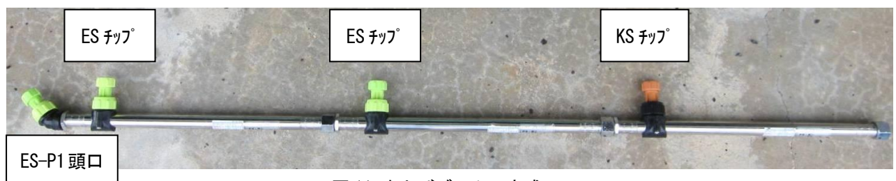
図 11 吹上げブームの完成
