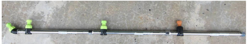
図 7 改良防除器具(吹上げブーム)
