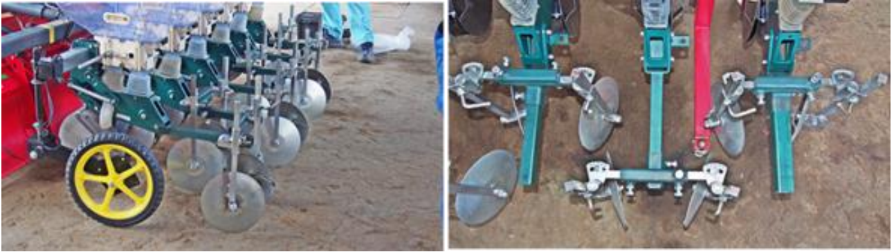
図3 小畦立て播種装置装着図. ベース機 : RXG-6PSE (アグリテクノ矢崎) 覆土板をはずして、鎮圧輪を小畦立て装置に換装する。 ディスクオープナを、作土に1~2cm 食込むように調整し、後ろの装置を 前の装置より5cm 低く設定する。
