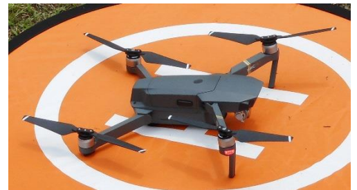
図1 可視光カメラ搭載ドローン
