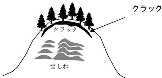
図 1 斜面の亀裂(クラック)
