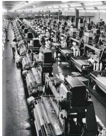
ウォータージェット織機の導入を中心に近代化された織物工場（1984年）
