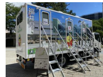
トイレトラック
