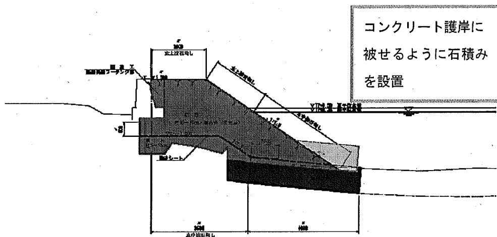
図 3.1-16 石積み護岸の断面図（三方湖で施工された護岸）
