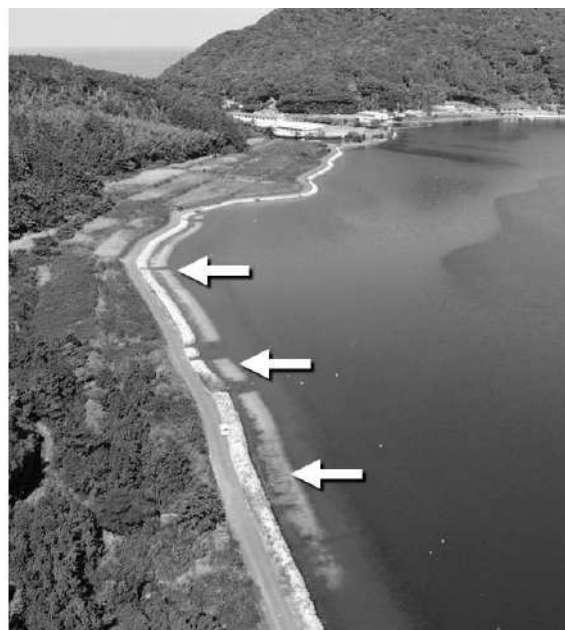
図3. 久々子湖の北西岸における養浜（R6年度度美浜町事業）。矢印の先にある白の帯状の部分が養浜箇所。
