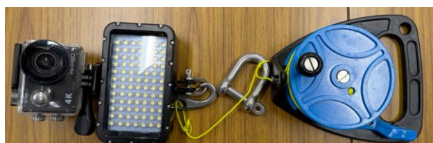
図 3. 簡易湖底観察カメラ。定点観測のためのカメラは、より大型のものになるが、この小型版を用いることで、局所的なスポット観測を簡易に行うことができる。
