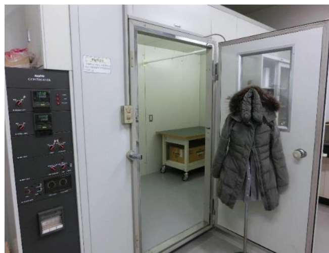
図2 プレハブ型恒温恒湿室の外観
