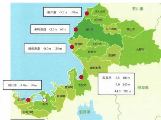
県内の耐震岸壁整備状況
