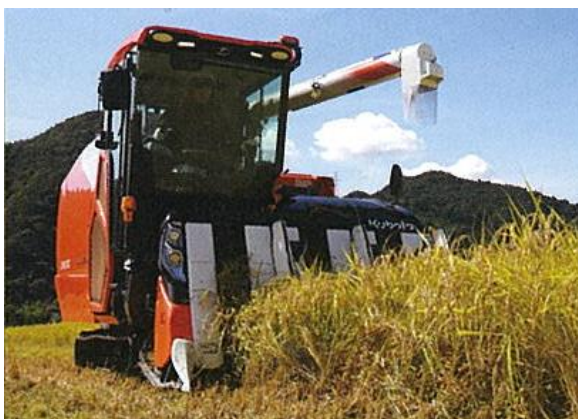
【収量を測定できるコンバイン】
