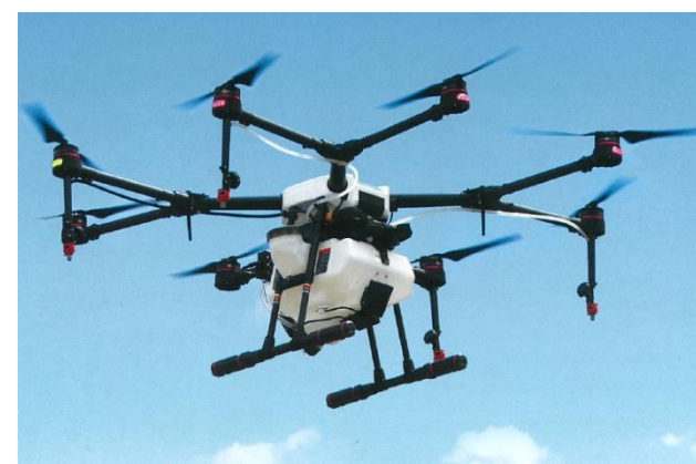
【ドローンによる農薬散布】
