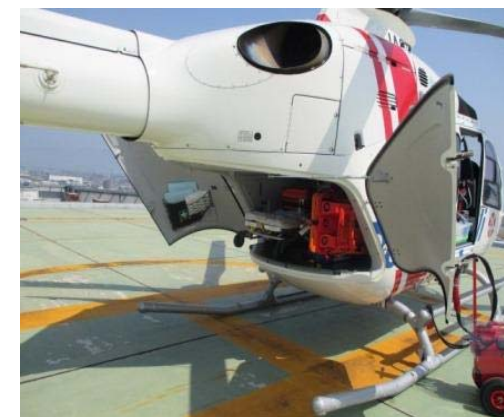
【担架による搬入口】
