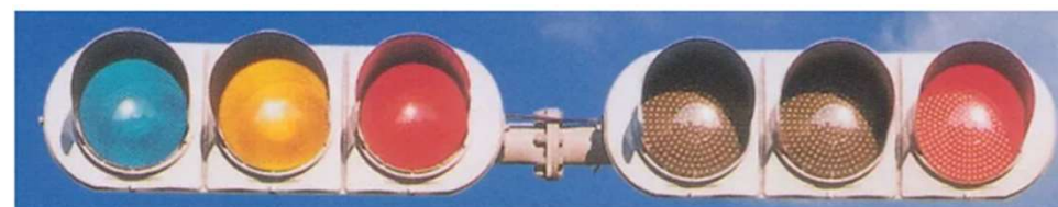
電球式信号灯器 (すべてが点灯しているように見える)
